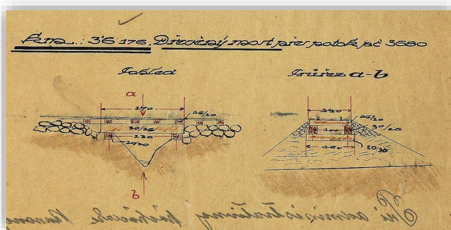
Projekt skutočného vyhotovenia mosta v kilometri 3,617. MV SR, SNA, f. KÚ – Adm, a. š. 938
